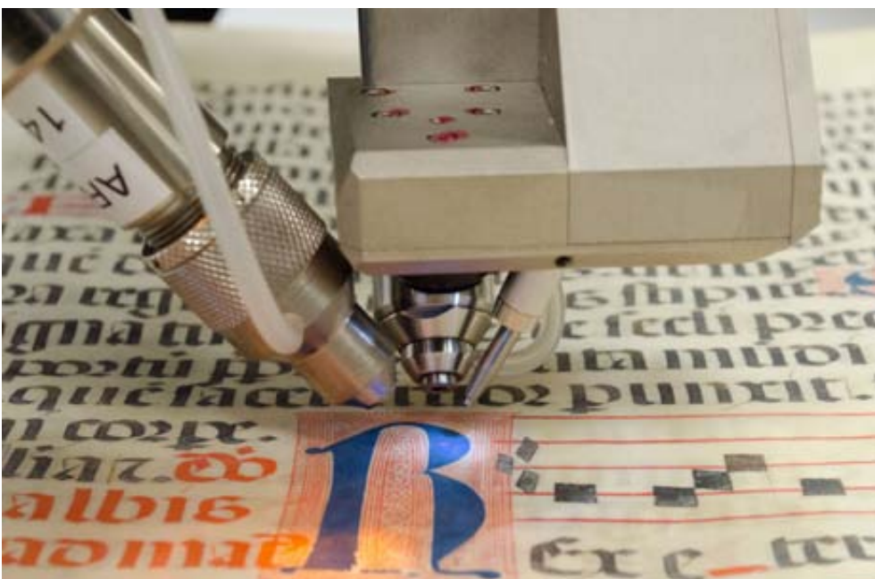
Röntgenfluoreszenz-Spektrometer bei einer Materialanalyse eines Manuskriptes
