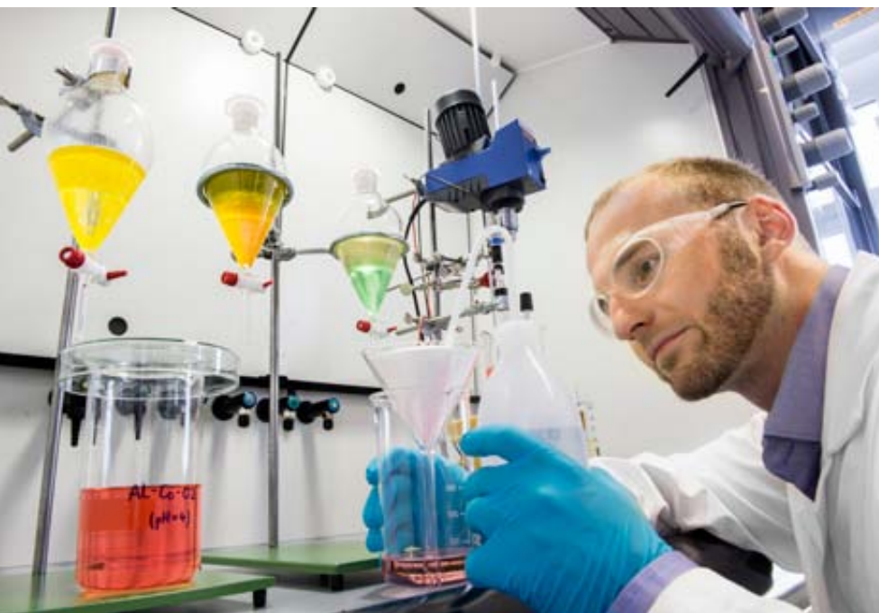
Die Recyclingexperten des Helmholtz-Zentrums Dresden-Rossendorf untersuchen, wie man Seltene Erden in den Rohstoff-Kreislauf zurückführen kann. Sie wenden ein spezielles Extraktionsverfahren an, um die kostbaren Metalle voneinander sowie von anderen Elementen abzutrennen.
