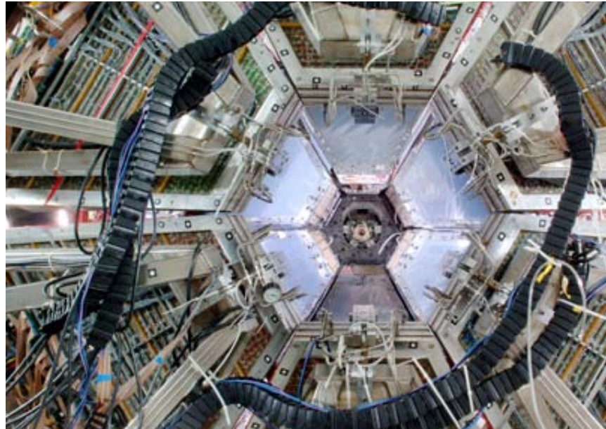
Blick in das Innere des Großdetektors HADES am GSI Helmholtzzentrum für Schwerionenforschung in Darmstadt. Der haushohe Messaufbau wird ein Teil der zukünftigen internationalen Beschleunigeranlage FAIR sein, die aktuell bei GSI gebaut wird.
