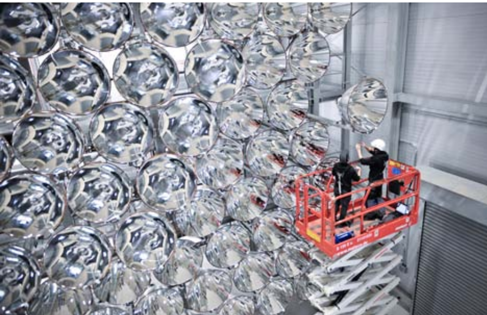
In Jülich betreibt das DLR mit dem Hochleistungsstrahler Synlight die größte künstliche „Sonne“ der Welt. Forschungsschwerpunkt der kommenden Jahre wird die Entwicklung von solaren Brennstoffen sein. Synlight wurde im März 2017 in Betrieb genommen.
