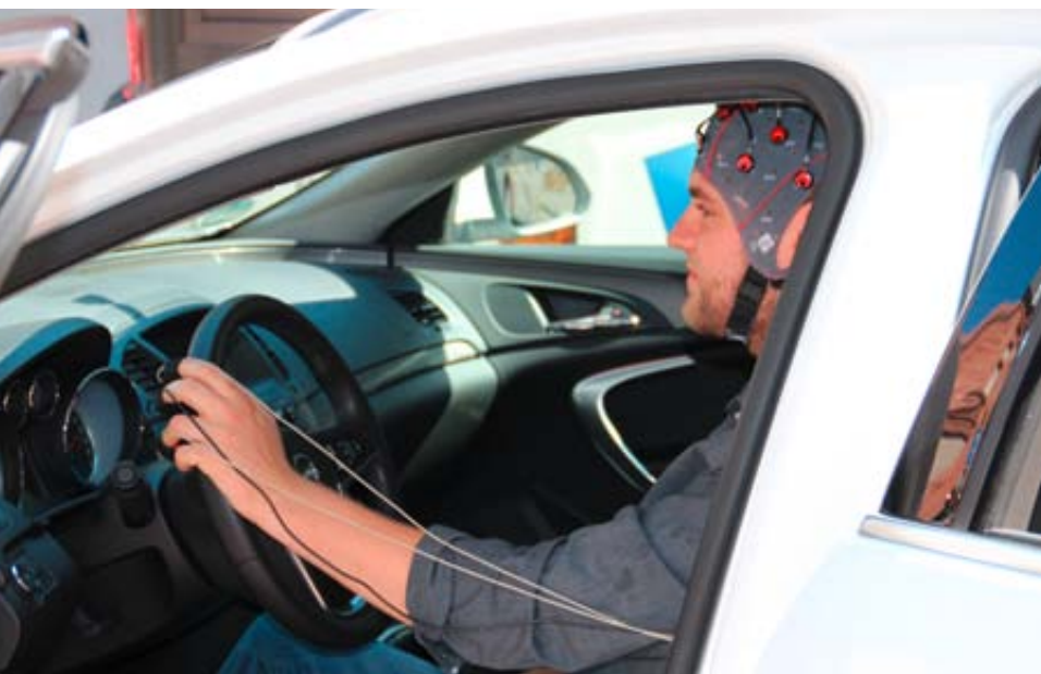
Proband im Forschungsfahrzeug: Messung psychophysiologischer Korrelate der Aufmerksamkeit (EEG und Hautleitwert) in Fahrsituationen im ITS (Intelligent Transportation Systems)-Testfeld Merzig (ITeM) der htw saar
