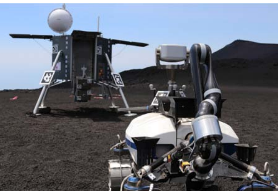
Der Rover LRU-2 (Light Wight Rover Unit) erstellt im Projekt ROBEX über seine Kameraaugen eine Karte der Umgebung und wählt sich seinen Weg zum Lander.
