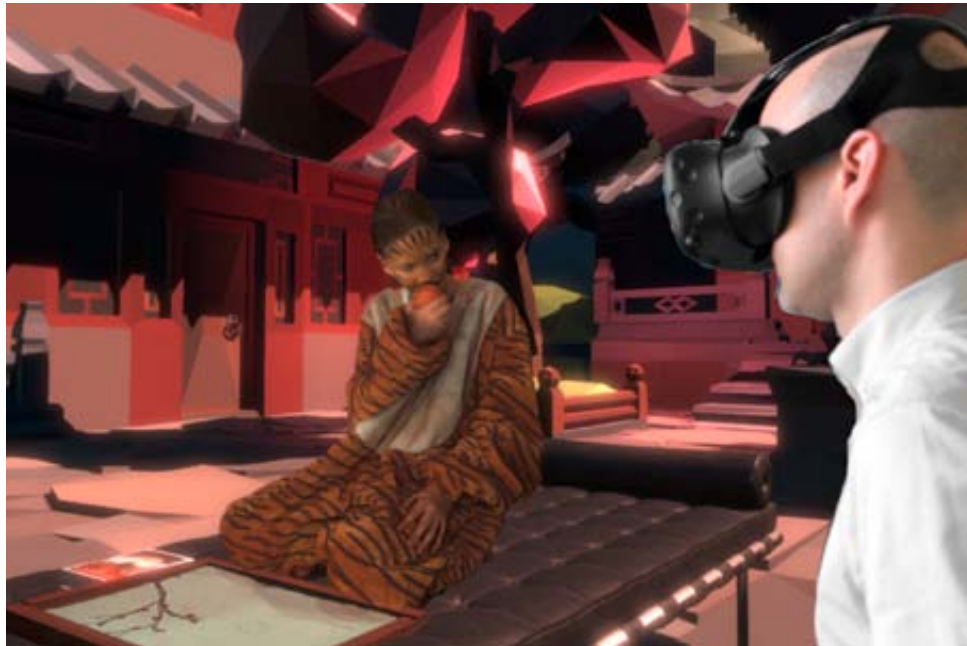
Die 3D-Human-Body-Reconstruction-Technologie des Fraunhofer-Instituts für Nachrichtentechnik, Heinrich-Hertz-Institut HHI nimmt reale Personen mit mehreren Kameras gleichzeitig auf und erstellt daraus natürlich bewegende, dynamische 3D-Modelle.
